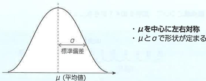
正規分布では、データが平均( $\mu$ )から $\pm k\sigma$ の範囲に入る確率は、 $\mu$ や $\sigma$ によらず一定です。たとえば、データが  $\mu \pm \sigma$ ,  $\mu \pm 2\sigma$ ,  $\mu \pm 3\sigma$  の範囲に入る確率は、それぞれおよそ 68.3%, 95.4%, 99.7% となります。製造業などで「良品率3σ」という目標を掲げることがあります。これは1,000個製造したとき 997 個が良品となるよう、製品のばらつきを減少させることを意味します。
