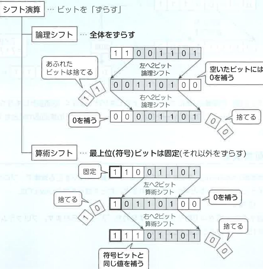
原則として、シフトによってあふれたピットは捨てられ、空いたピットには0が補充されます。ただし、算術右シフトに限っては空いたピットには「符号ピットと同じピット」を補充します。なお、次の条件を満たす限り、左へ1ピットシフトした結果は元の2倍の値となり、右に1ピットシフトした結果は元の1/2倍の値となります。
