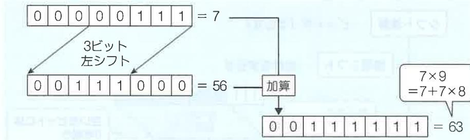
シフトを用いた乗算は、単にプログラム上の工夫だけではなく、回路設計にも役立っています。実際に乗算回路をもつコンピュータでは、それをシフト回路と加算回路の組合せで構築しています。
