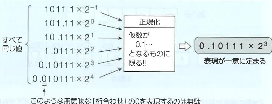
正規化は表現を一意に定め、**有効数字の桁数を確保する**ための操作です。正規化のために小数点を移動させことがあります。小数点を左に1桁移動させた場合には、指数を1増加させて調整します。逆に右に1桁移動すると指数は1減少します。
